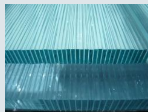
トヨタブースのキューブ型のLEDとガラスステージ。床面のガラスは細長いガラスを縦に使って側面が天板に。
